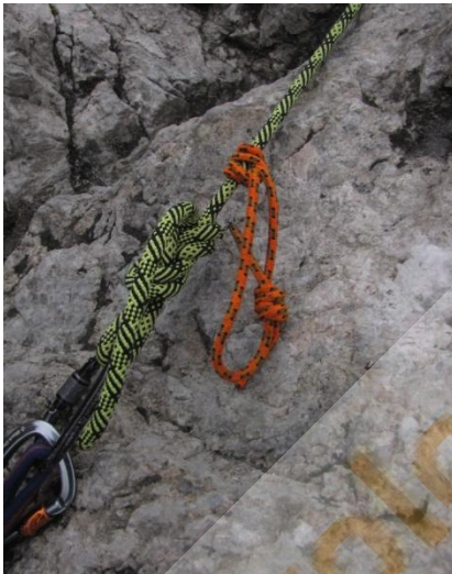
Samo-zatezni vozle – Prusikov vozle
